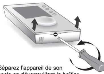
Séparez l'appareil de son socle en déverrouillant le boîtier.
