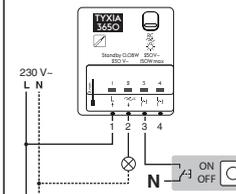
Dans ce cas, câblez les boutons poussoirs au Neutre s'il est accessible. Sinon, installez une charge résistive CR1W réf.: 6353001.
