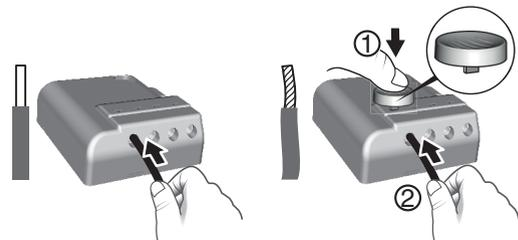
A l'aide de l'outil fourni ou d'un tournevis de 2,5 mm, appuyez sur le bouton de la borne puis insérez le fil.
