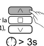
Puis, appuyez ~3 secondes sur la touche  $\wedge$  jusqu'à ce que le moteur s'actionne brièvement. La butée manuelle haute est enregistrée.
