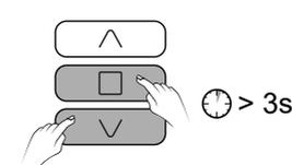
Sur l'émetteur, appuyez simultanément plus de 3 secondes sur les touches v et □, jusqu'à ce que le voyant s'allume.
