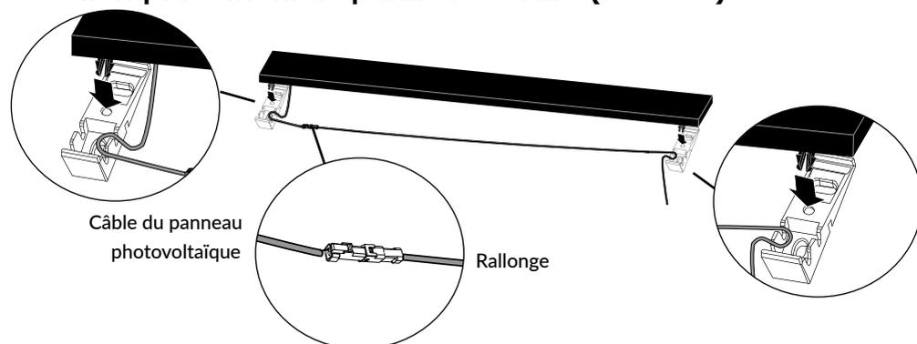
Pour déclipper le panneau et le cadre de ses supports ou du coffre, munissez-vous d'un petit tournevis plat et appuyez sur les pions au niveau des trous de clippage.
