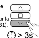
Puis, appuyez ~3 secondes sur la touche  $\vee$  jusqu'à ce que le moteur s'actionne brièvement. La butée manuelle basse est enregistrée.
