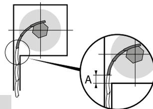
La première lame doit être engagée dans les guides latéraux lorsque le tablier est complètement descendu.
