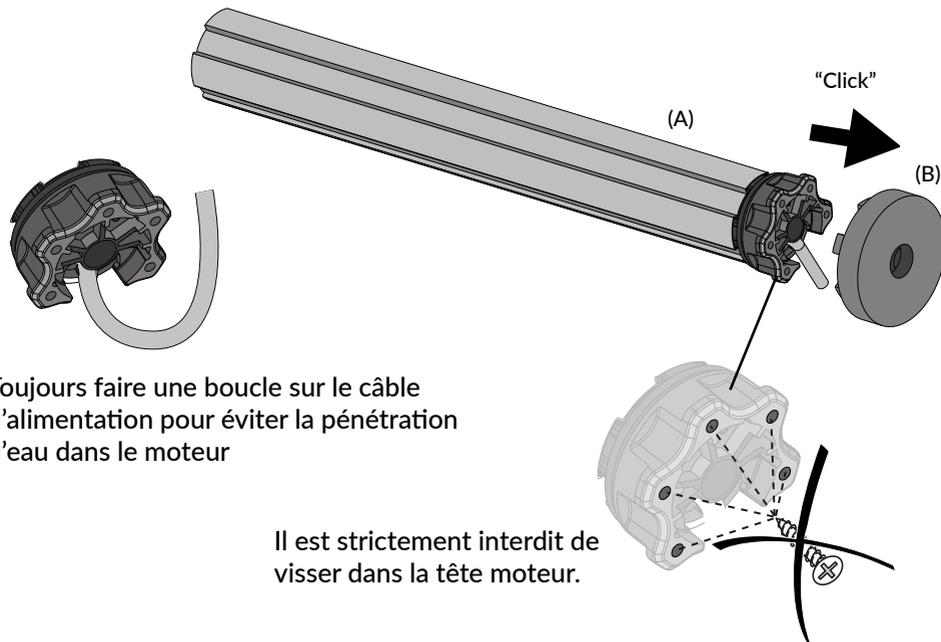
Toujours faire une boucle sur le câble d'alimentation pour éviter la pénétration d'eau dans le moteur
