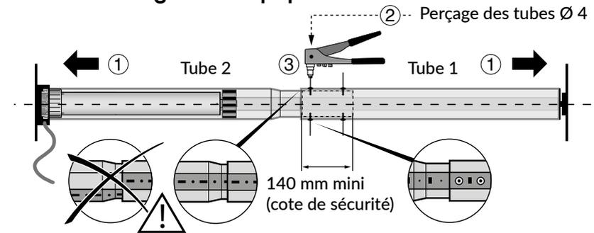
Utilisez impérativement les 4 rivets aveugles fournis pour assembler chaque élément des tubes télescopiques
